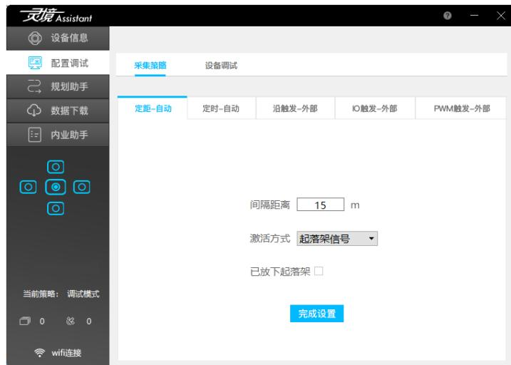
“起落架信号”方式适用于带有可收放起落架的无人机使用，要求将灵境设备与起落架信号线相连。
